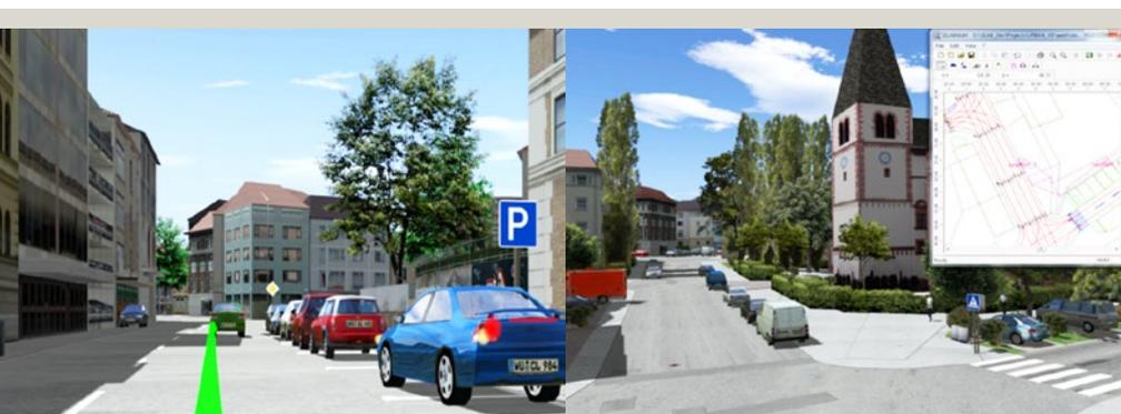
Abb. 2: Einsatz technischer Features zur Verdeutlichung von Trainingsinhalten: Links: Der grüne Balken zeigt einen unkritischen Abstand zum vorausfahrenden Fahrzeug. Rechts: Bei der Nachbesprechung können kritische Teile der Fahrt aus der Vogelperspektive betrachtet werden.
