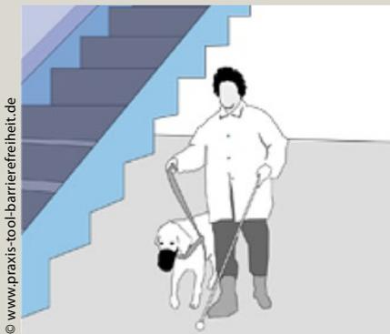
Abb. 4: Unterlaufbare Treppe als potenzielle Verletzungsgefahr für Sehbehinderte
